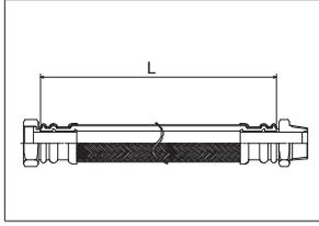
※継手本体の標準接続は一端が袋ナット（平行ねじ）でパッキン付、他端は外ねじ（テーパねじ）です。
